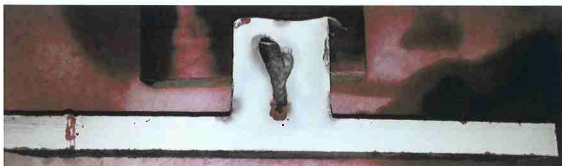
Figura 31 - Superfície de corte da peça 8, durante ensaio por líquido penetrante.
