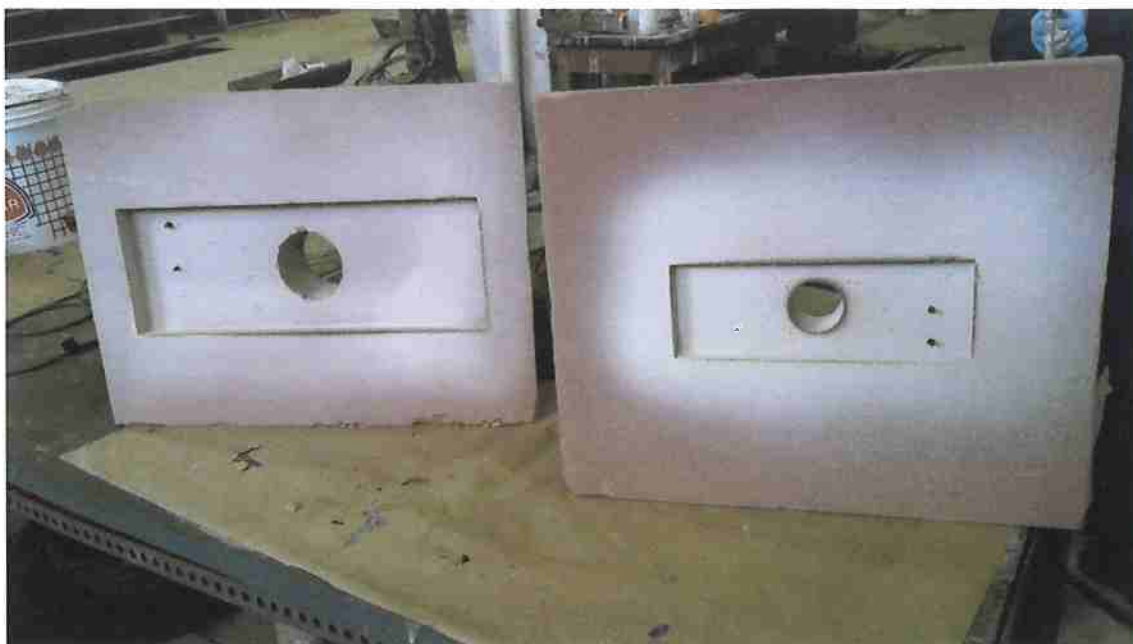
Figura 16 - Caixas-tampa das peças 13 (esquerda) e 8 (direita), após queima e pintura dos moldes.
