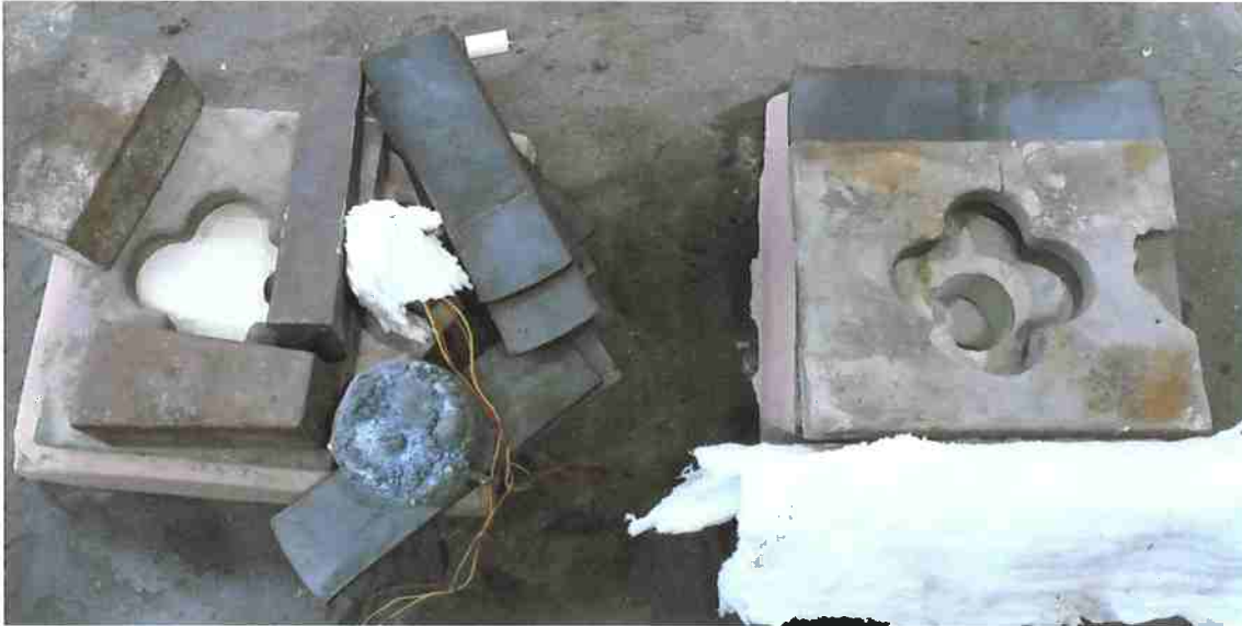
Figura 20 - Moldes finalizados e prontos para o vazamento.
