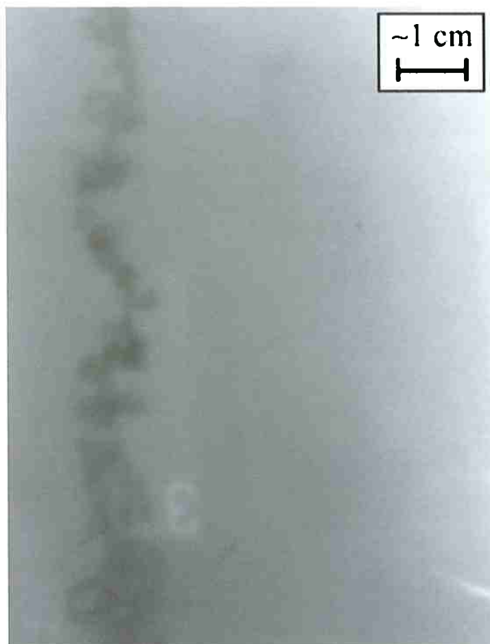
Figura 1 - Radiografia de uma amostra em placa, com a região esquerda apresentando porosidade em linha central e região direita sã. (OU et al., 2002a)
