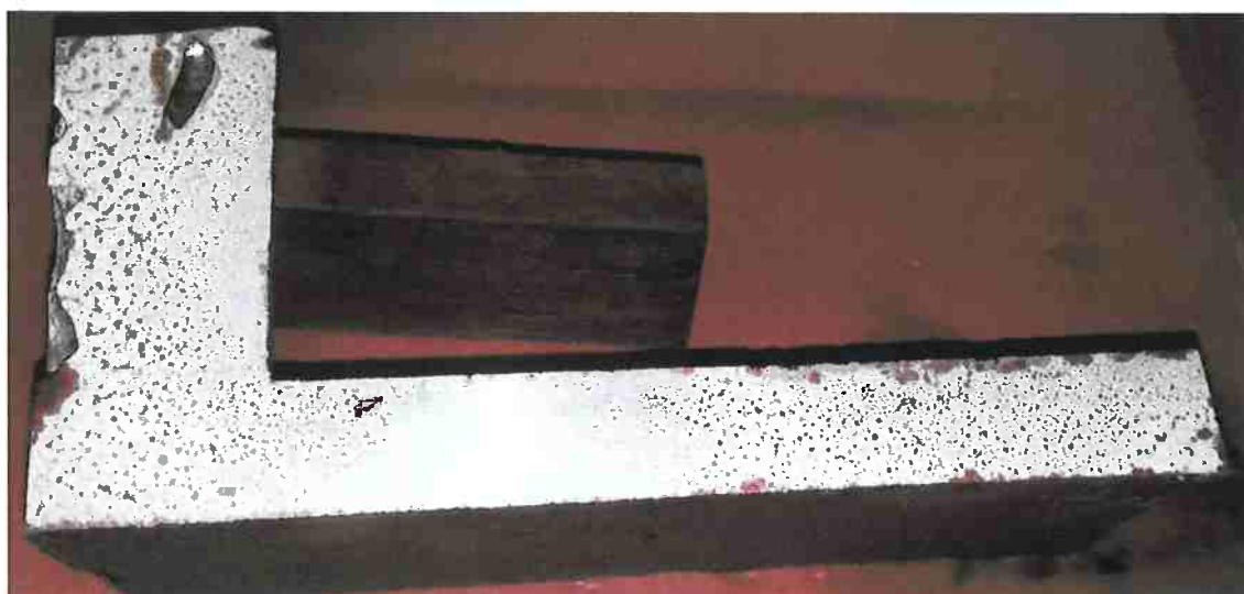
Figura 30 – Superfície de corte da peça 13, durante ensaio por líquido penetrante.
